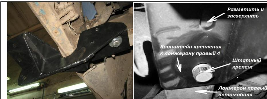
Установить правый кронштейн крепления б на лонжерон автомобиля. Закрепить болтом крепления штатного бампера так , чтобы болт располагался по центру паза. Аналогично установить левый кронштейн.
