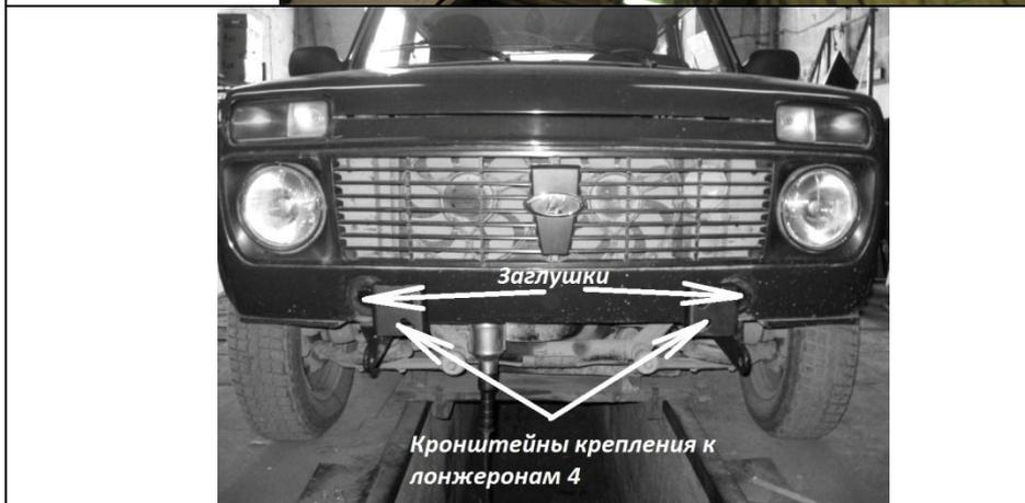
После установки обеих кронштейнов на лонжероны автомобиля затянуть крепеж и установить заглушки.
