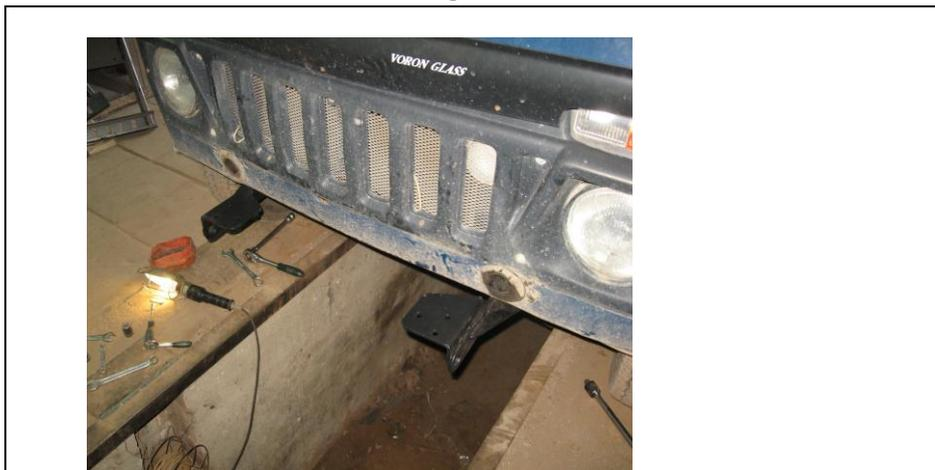
Полки кронштейнов образуют посадочную плоскость, на которую устанавливается бампер.
