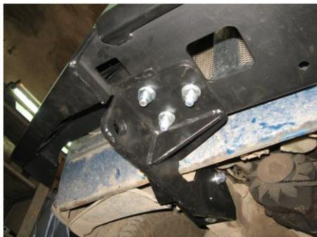
Выравнивание бампера относительно кузова.
