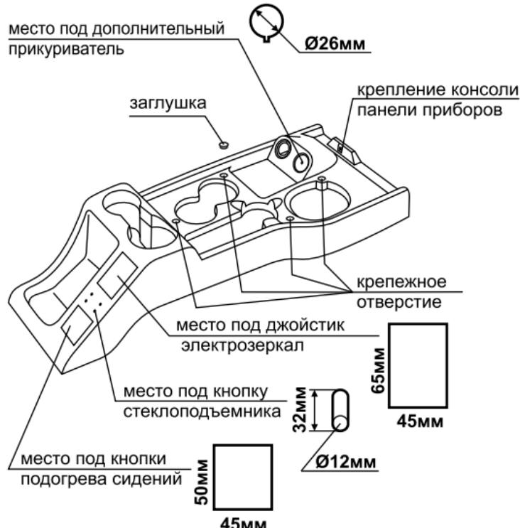
Для установки потребуется: отвертка короткая с крестообразным шлицем, а также, в зависимости от установки дополнительных элементов - нож, дрель, сверла.
